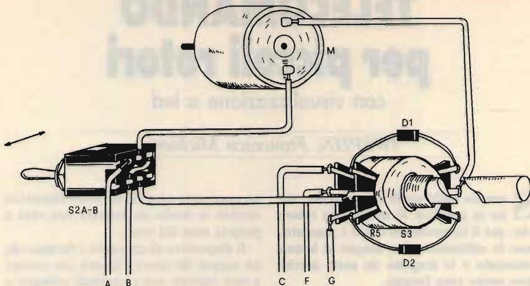
VISTA: DEVIATORE; MOTORE; POTENZIOMETRO E DEVIATORE ROTATIVO
