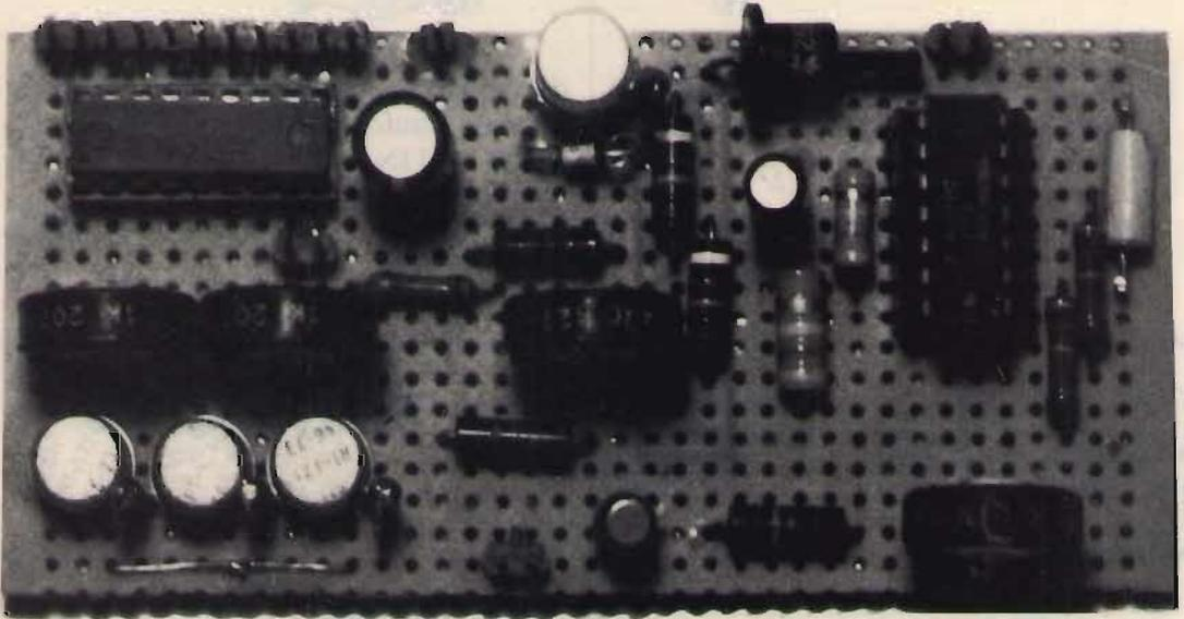
sione di riferimento è usata nel suo valore tipico di 1,25 V. La particolarità è data dai circuiti aggiunti che permettono un allarme acustico intermittente quando siano accesi  $D_{L10}$  e/o  $D_{L9}$ .
