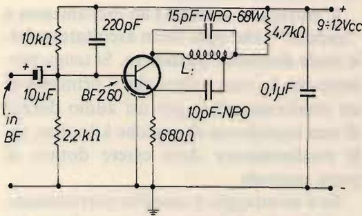
$L_1$  7 spire filo rame argentato  $\varnothing$  0,5 mm, avvolte in aria su  $\varnothing$  8 mm; presa alla terza spira dal lato "freddo"; stirare la bobina per 15 mm.
