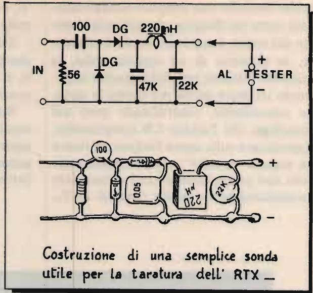
Costruzione di una semplice sonda utile per la taratura dell' RTX —
