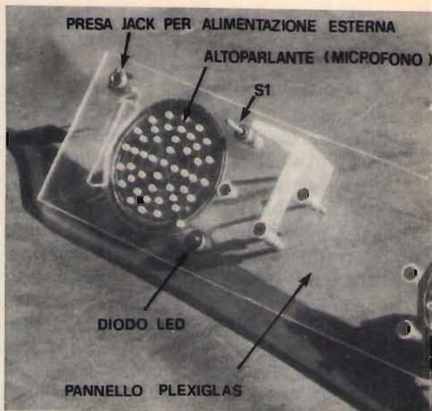
Si inizia costruendo il pannello frontale in plexiglass. Occorrerà praticare una serie di forellini in corrispondenza dei due altoparlanti (di cui uno funge da microfono). Sopra quest'ultimo si praticeranno altri due fori in cui verranno alloggiati il diodo LED e l'interruttore. Al di sotto di questo, invece, un altro foro permetterà l'alloggiamento dell'innesto jack per l'alimentazione esterna. ▲
