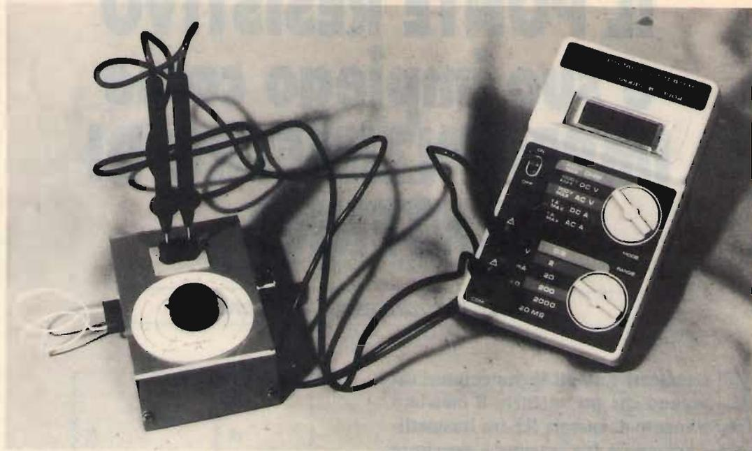
Qui possiamo vedere un possibile impiego dell'impedenziometro abbinato a un multimetro; in questo caso la lettura sulla scala del multimetro elimina tutti gli errori di interpretazione che potevano sorgere adoperando lo strumentino da 50 o 100  $\mu$ A dell'impedenziometro.
