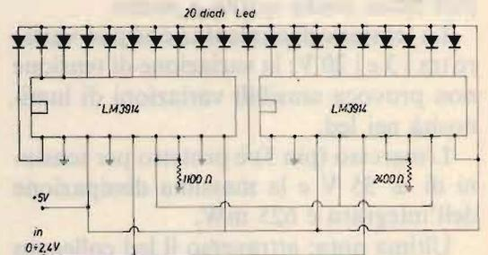
Infine in figura 11 è mostrato lo schema di un indicatore di tensione da me usato in un caricabatterie. La scala va da 10 a 14,5 V con gradini di 0,5 V. La ten-
