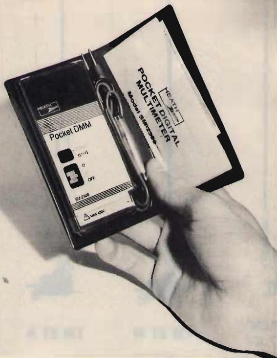
A doppia integrazione, con display a cristalli liquidi (massima lettura 1999), cambio automatico di portata e di polarità. Misurazioni di tensione continua ed alternata (fino a 1999 mV e 400 V), della resistenza (fino a 200  $\Omega$  e 1999 k $\Omega$ ).
