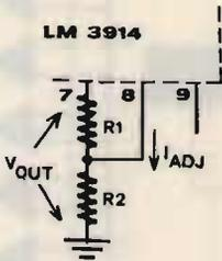
Il termine  $I_{adj} \cdot R_2$  può essere considerato trascurabile essendo il valore di  $I_{adj}$  mediamente  $80 \mu A$ , ovvero 0,00008 amper.
